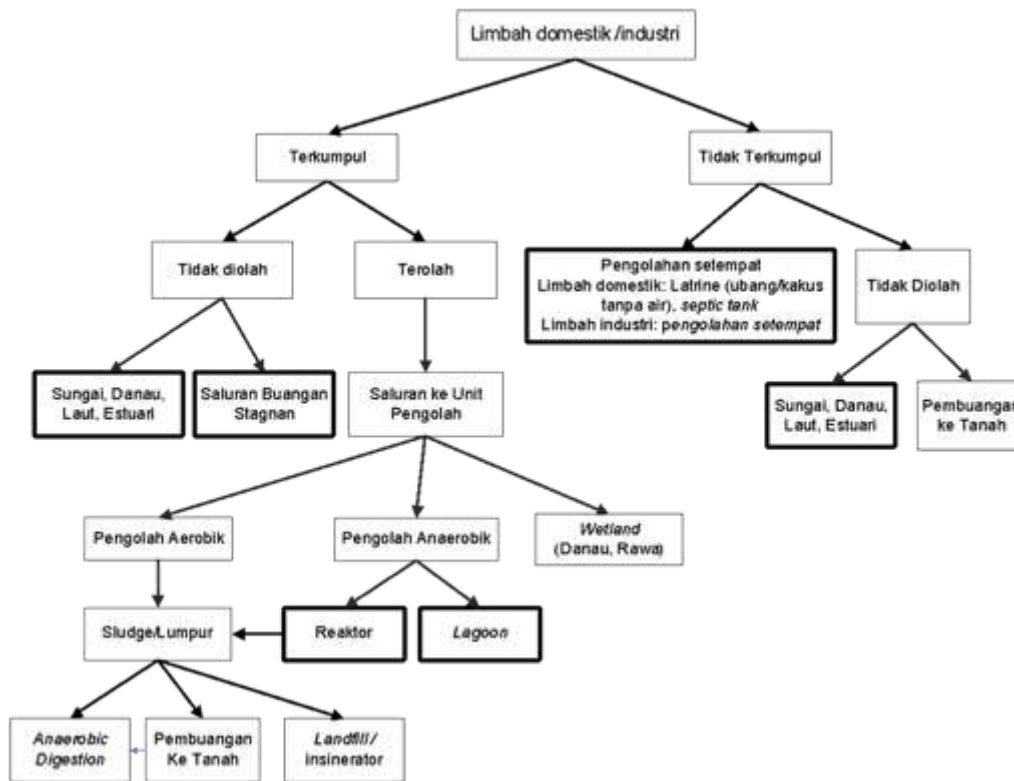
Gambar 4-2 Skema Aliran Pengolahan dan Pembuangan Limbah Cair Domestik/Industri
